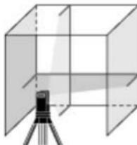
**Aviso:** El nivel de láser puede compensar pendientes de +/- 6°. Si el nivel se coloca en una pendiente muy pronunciada, no podrá autonivelarse con precisión.
